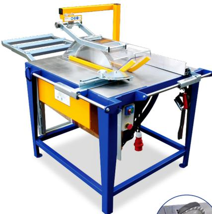
Wenn Sie das Blatt bis 45 Grad schräg stellen wollen, ist diese Baukreissäge genau richtig. Sie ist für gehobene Ansprüche im Schalungsbau, wie für Liftschacht- und Rundschalungen, genaue Winkelstösse, gewundene Treppen, Pilzköpfe und Pfeilerformen, gebaut. Mit ihr macht Gehrungssägen einfach Spass.
