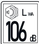
Garantierter Schalleistungspegel; Messung nach EN ISO 3746
